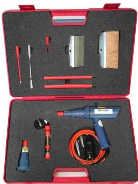
شکل ۱۰: نمایی از تجهیزات آزمایش جرقه الکتریکی
