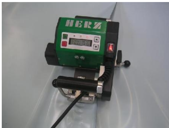
شکل ۵: دستگاه جوش دوگانه برای جوش ژئوممبرین ها
